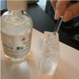
こちらの写真は、アクリル材にφ6.4mmの加工を行った後に、樹脂の涙（アクリルの液体）を流し入れ、その後にφ6mmのアクリル丸棒を挿入したものです。挿入後に低湿度環境下でしばらく乾燥固化させます。
